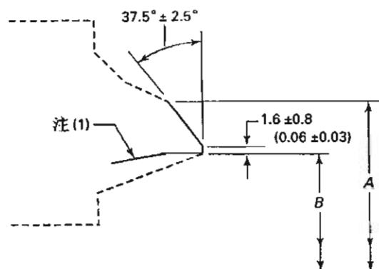
(a) 无背环连接的焊端细部图
