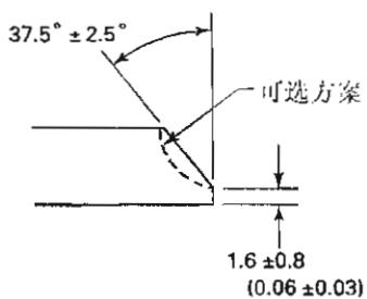
通注:(a) 本细部图适用于根部焊道的钨极气体保护焊(GTAW), $3\text{mm}(0.12\text{英寸}) < \text{公称壁厚} \leq 10\text{mm}(0.38\text{英寸})$ 。
