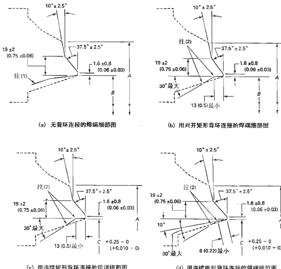
通注:(a) 虚线表示从焊接坡口和根面到部件本体过渡的最大包络线,详见图1。
