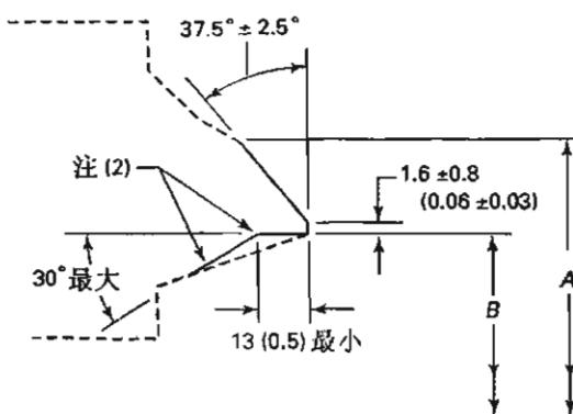
(b) 用对开矩形背环连接的焊端细部图
