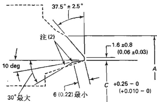
(d) 用连续锥形背环连接的焊端细部图
