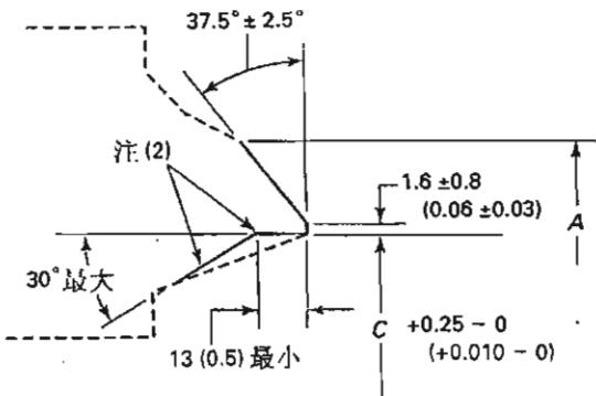
(c) 用连续矩形背环连接的焊端细部图
