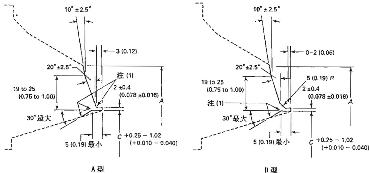
通注:(a) 本细部图适用于根部焊道钨极气体保护焊(GTAW),公称壁厚>25mm(1.0英寸)。
